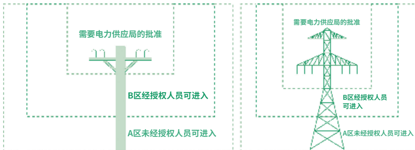
图2 架空电力线路杆附近的作业区域。
